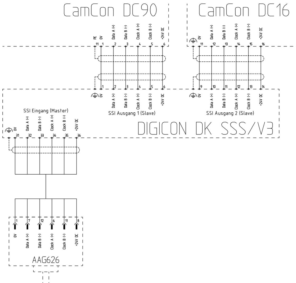
7.2. Anschlußbeispiel Mithör - Mode eines Multiturn - Gebers mit 4096\*4096 (24 Bit)
