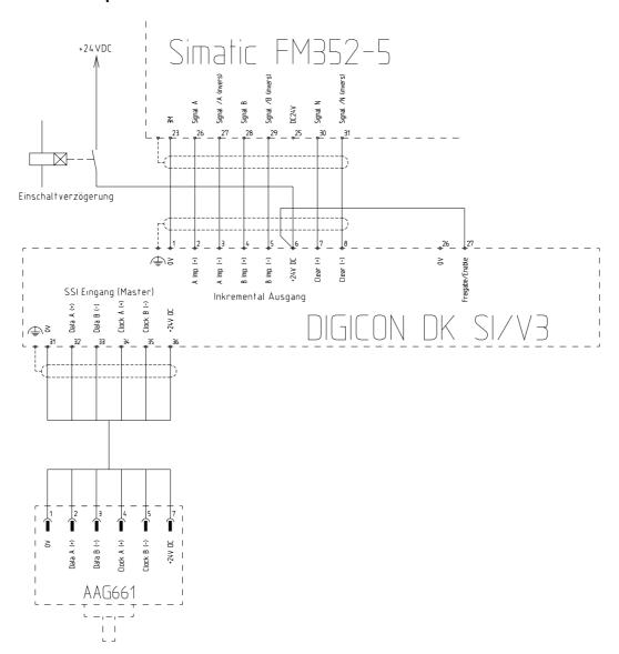
In diesem Beispiel wird das DK SI/V3 mit einer Simatic FM352-5 Nockenbaugruppe verbunden. Diese kann dem DIGICON kein Freigabe - bzw. Enable - Signal zur Verfügung stellen.
