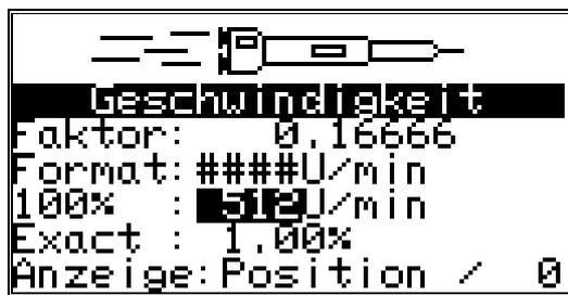
**Beispiel:** Bei einem 100% Wert von 512 U/min muß durch 64 geteilt werden, was einem Schiebefehl von SRW 6 entspricht.
