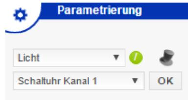
Im oberen Auswahlmenü wird der Anlagenteil und im unteren die Funktion ausgewählt.
