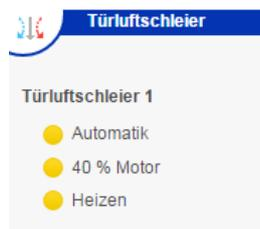
Hier wird der Status des / der Türluftschleier angezeigt. Neben Automatik bzw. Handbetrieb wird auch die Motorleistung in Prozent angegeben. Darüber hinaus wird angezeigt ob sich der Türluftschleier im Heizbetrieb befindet oder nicht. Ist zusätzlich ein Temperatursensor konfiguriert, wird auch die aktuelle Temperatur angezeigt.
